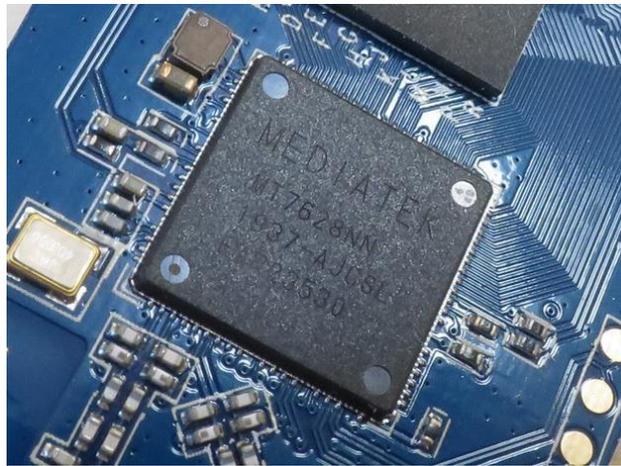
Mediatek MT7628NN. Однокристалльная система, специально предназначенная для интернета вещей и роутеров. На борту имеются выходы usb, PCI-e, SD-XC и много еще чего. WiFi 802.11n 2T2R интегрирован в чип. Все это работает на частоте 580 МГц. Ну что ж, производительности хватит с запасом.
