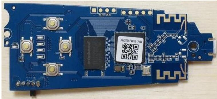
Антенны в виде дорожек на плате. Две кнопки на увеличение и уменьшение подсветки, одна на запись видео и фото, одна - ресет. Четыре светодиода для отображения уровня заряда батареи и один индикаторный. Ползунковый включатель устройства на краю платы.
