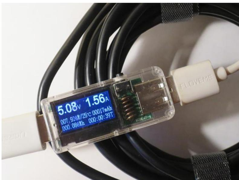
Ого! Более полутора ампер! Это очень большой ток для аккумулятора в 1000 мА·ч.
