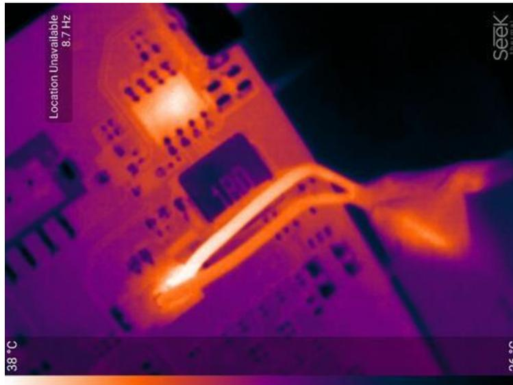
Даже провод на аккумулятор греется сильнее контроллера.
