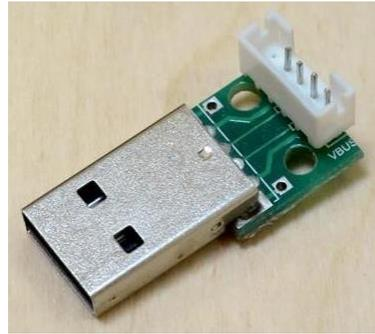
Четыре провода – стандарт USB, а пятая нога разъема – на светодиоды подсветки камеры. Я не стал их запитывать для тестирования. При желании подключить камеру к компьютеру помимо блока wifi, можно легко изготовить полнофункциональный переходник, с плавной регулировкой подсветки. Для этого нужно лишь припаять реостат между пятым и первым выводами разъема камеры.
