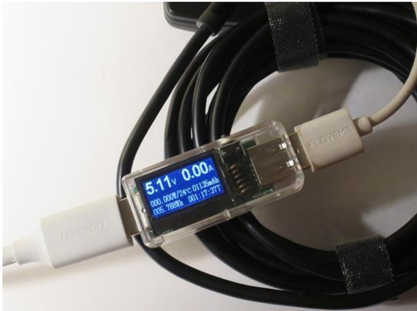
Аккумулятор зарядился полностью, потребовав 1135 мА·ч. Учитывая что прибор подключен к напряжению 5 вольт, а аккумулятор заряжается при напряжении в среднем 3,7 вольт, ток на аккумулятор будет в  $5/3,7 = 1,35$  раз выше, т.е. 2,1 А. Что втрое выше оптимального тока для аккумулятора емкостью 1000 мА·ч.
