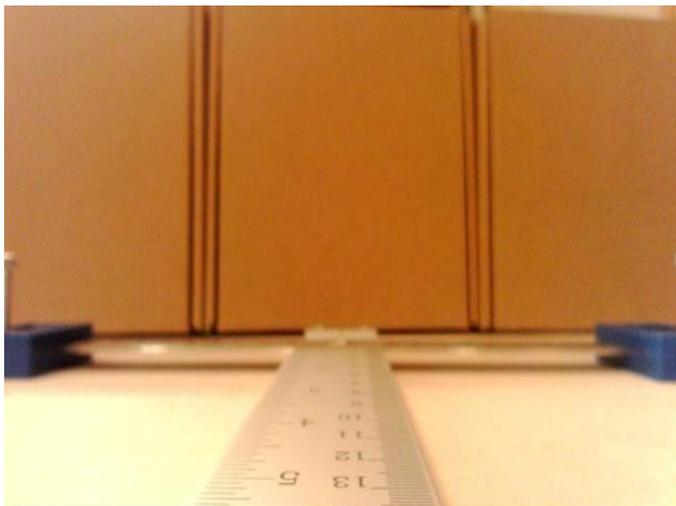
Дальность съемки 200 мм, расстояние между центрами кареток 244 мм. Математика позволяет вычислить угол обзора по горизонтали:  $63^\circ$ . При соотношении сторон кадра 16 к 9 диагональ кадра получается 280 мм, а угол по диагонали получается как раз  $70^\circ$ . Снова подтверждается заявленная в характеристиках цифра. Хорошо.
