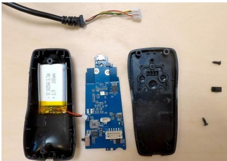
В кабеле, идущем к камере, пять проводов. Очевидно, четыре – стандарт usb, пятый желтый – для питания светодиодов подсветки. Присутствует экранирование и толстая жила (алюминиевая?) для придания жесткости.
